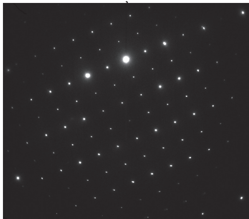
Figura 1.3 – Difração de elétrons por cristais de carbeto de cromo (CrC) em uma matriz de aço inox, obtida em um microscópio eletrônico de transmissão.
