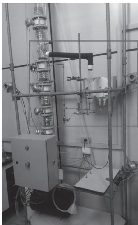
Figura 1.7 Coluna de destilação semicontínua, com refeedor isolado termicamente no fundo. Em destaque o sistema de refluxo que altera as condições de operação.
