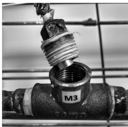
Figura 1.2 Microfone sendo acoplado internamente ao duto.
