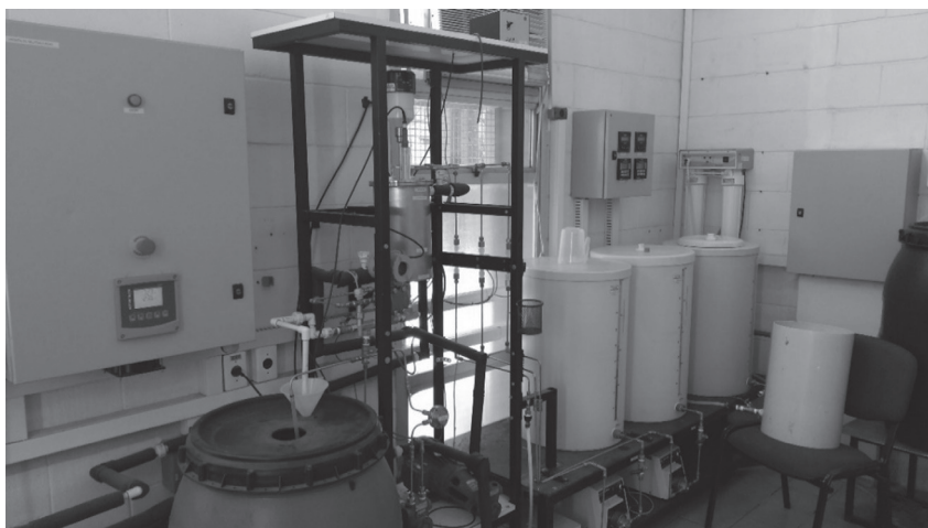
Figura 1.12 Ao centro, reator tanque agitado contínuo (CSTR) de aço inox, com sensores de pH e nível acoplados. Os três barriletes contêm soluções de ácido, base ou tampão a ser neutralizado. Abaixo deles estão as bombas dosadoras de rotação variável. A bombona azul coleta o meio reacional de saída contínua.
