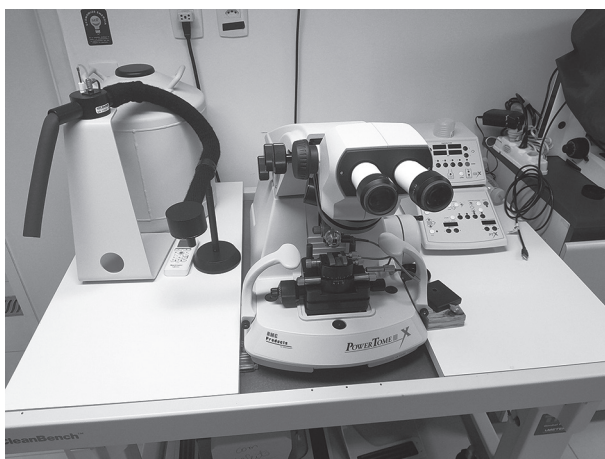
Figura 2.6 Criomicrotomo usado para cortar amostras poliméricas e biológicas para MEV.
