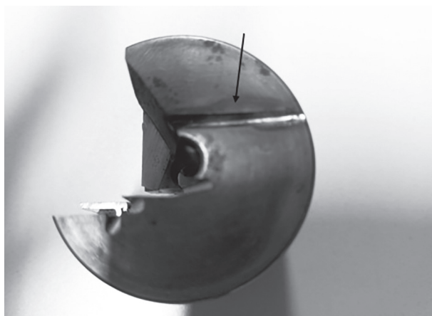
Figura 2.1 Amostra metalográfica “queimada” (escurecida) pelo corte com dano térmico.
