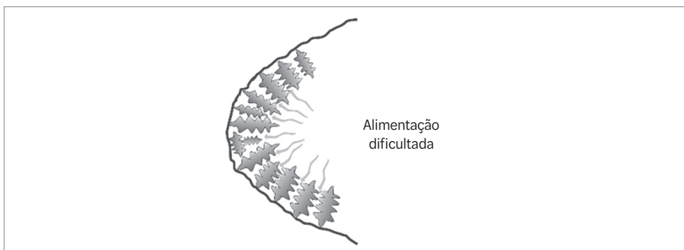
Figura 1.16 Desenho esquemático que mostra as dendritas se formando com certa dificuldade de serem alimentadas.
