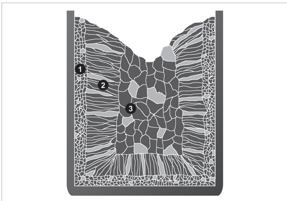
Figura 1.6 Macroestrutura bruta de fusão com suas respectivas zonas. 1. Zona coquilhada: região de contato direto com o molde (coquilha), a qual apresenta granulometria bem fina, de orientação randômica (microequiaxial). 2. Zona colunar: região que cresce de modo alinhado, em geral na direção do fluxo de calor, com grãos grandes e alongados. 3. Zona equiaxial: zona de grãos equiaxiais com dimensões superiores aos da zona coquilhada.
