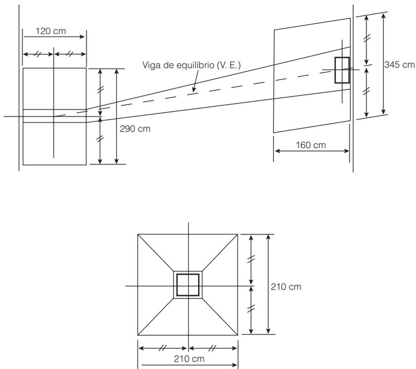
18.º Exercício: Calcular as dimensões de uma sapata para suportar um pilar de  $20 \times 150$  cm com as seguintes cargas:
