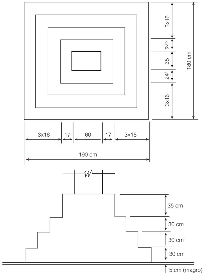
2.º Exercício: Dimensionar uma sapata para um pilar de  $30 \times 30$  cm e carga de 1 500 kN, sendo a taxa admissível no solo igual a 0,3 MPa.
