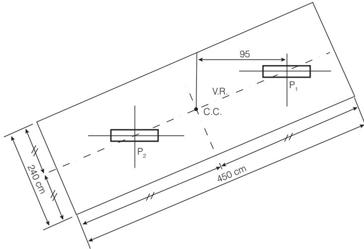
7.º Exercício: Dimensionar as sapatas dos pilares P<sub>1</sub> e P<sub>2</sub> indicados abaixo, sendo a taxa no solo  $\sigma_s = 0,3$  MPa.
