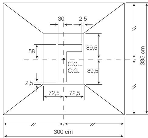
5.º Exercício: Projetar uma sapata para o pilar abaixo para  $\sigma_s = 0,3 \text{ MPa}$ .
