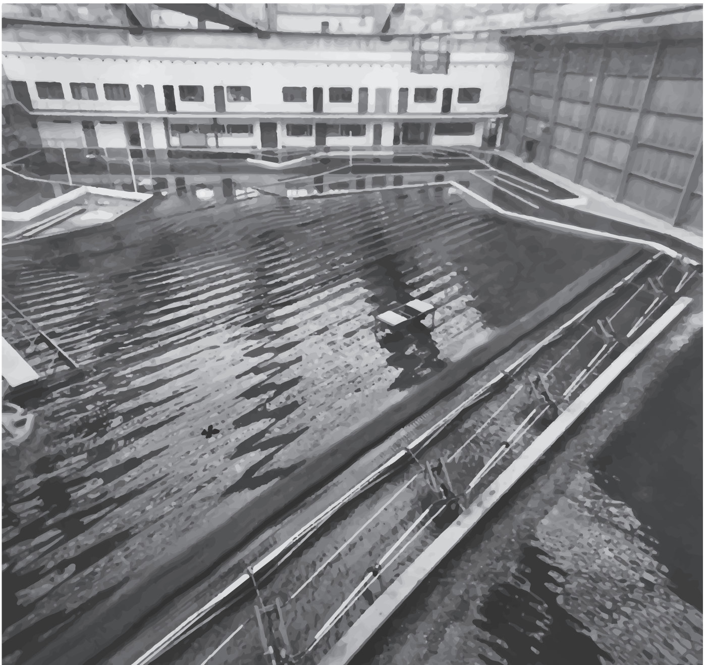
Modelo físico da Barra Lagunar de Cananeia (SP) para estudos de melhoramentos para a navegação (1955 a 1972). Escala horizontal 1:400, escala vertical 1:100, com simulação da maré, geração de ondas e fundo móvel.
