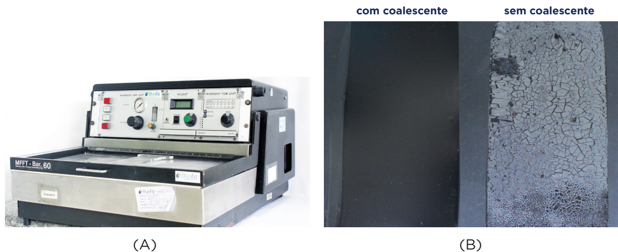
Figura 1.5: Equipamento para determinação da TMFF (A) e exemplo de formação de filme de látex com e sem adição de agentes que promovam a coalescência (B).
