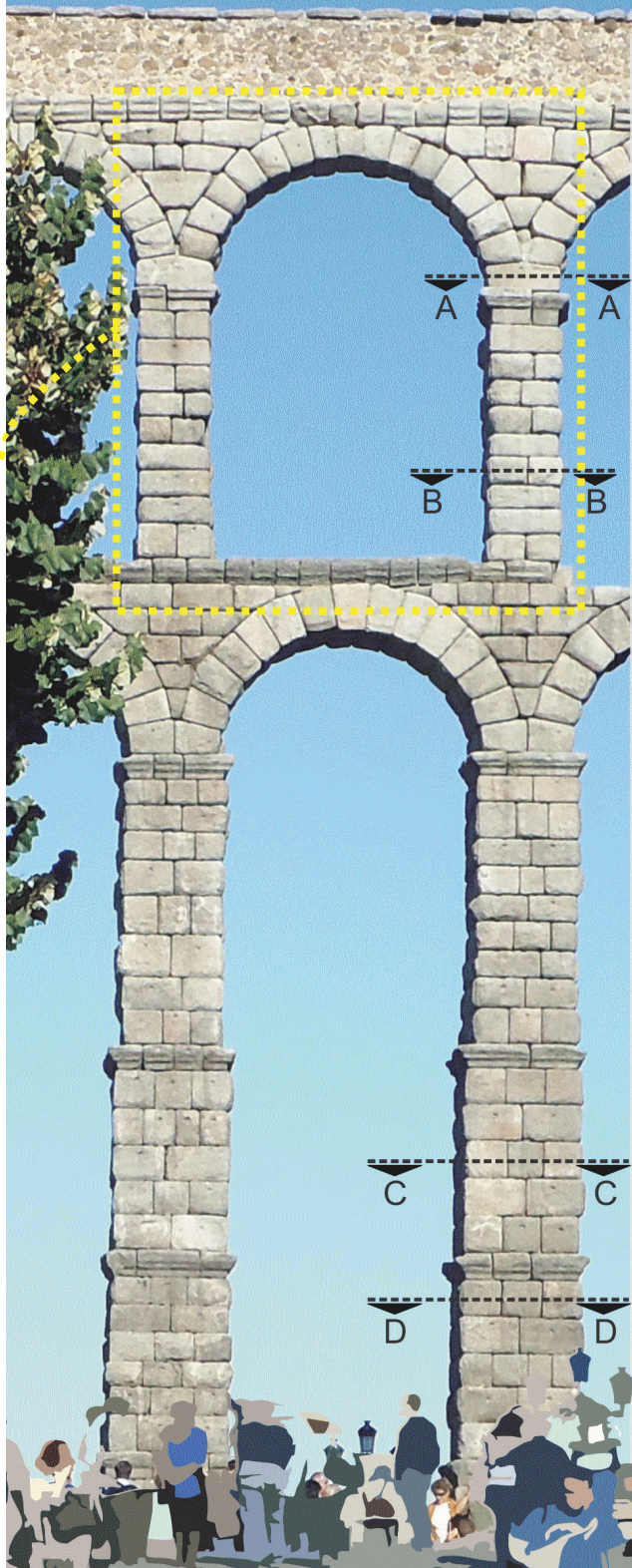
Figura 1.6 – Detalhes e cortes do aqueduto romano de Segóvia, Espanha.
