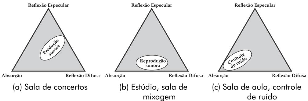
**Figura 1.21** Equilíbrio entre absorção reflexão especular e reflexão difusa [17].
