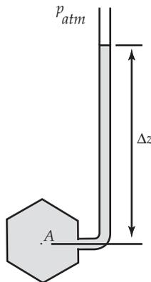
Figura 1.6 Piezômetro
