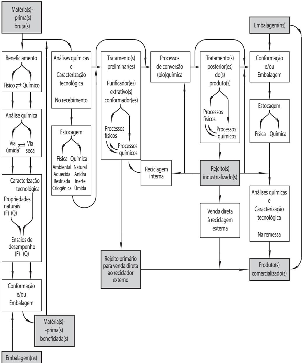
**Figura 1.3** Fluxograma de um processo genérico (CREMASCO, 2010).
