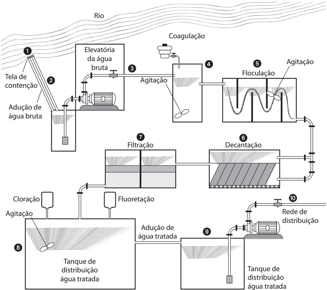
**Figura 1.2** Processo simplificado de tratamento de água (baseada em O<sub>2</sub> ENGENHARIA E SANEAMENTO AMBIENTAL, 2011).
