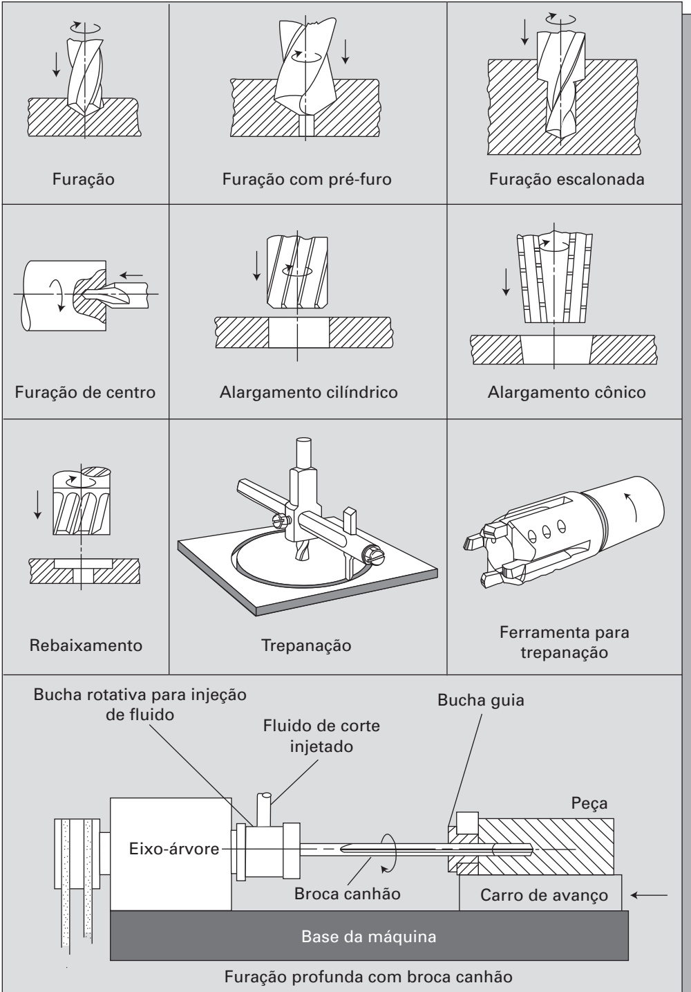
FIGURA 1.3 Principais operações executadas na furadeira.
