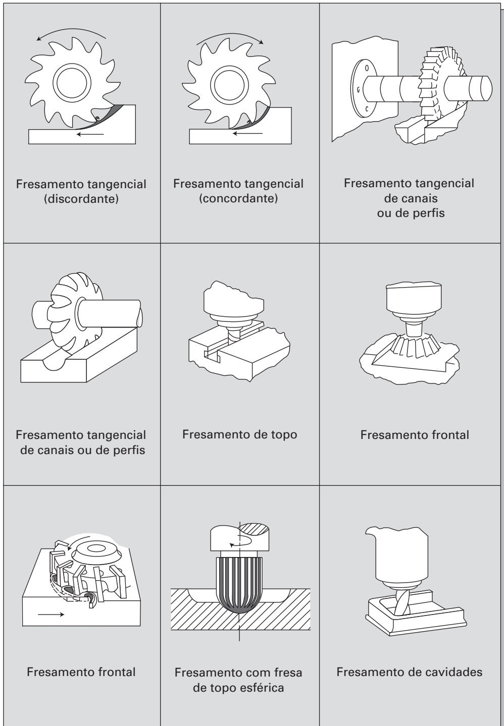
FIGURA 1.4 Principais operações executadas na fresadora.
