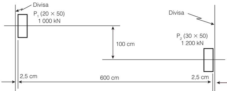
Este caso pode ser resolvido como sendo a superposição de dois casos de pilares de divisa com viga de equilíbrio. Inicialmente, calcula-se a largura  $b$  das sapatas partindo da relação  $a = 2b$  e  $\Delta P = 0$ .
