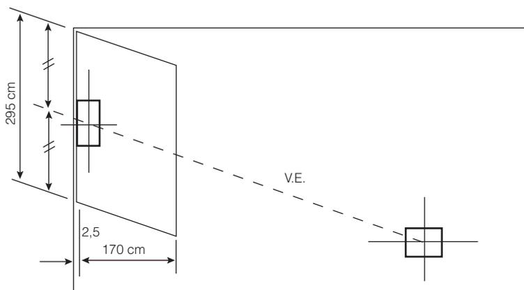
12.<sup>o</sup> Exercício: Dimensionar as sapatas dos pilares indicados para uma taxa no solo de 0,3 MPa.
