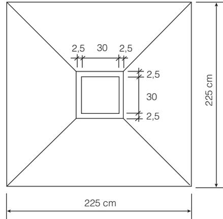
3.º Exercício: Dimensionar uma sapata para um pilar de seção  $30 \times 100$  cm, com carga 3 000 kN, para um  $\sigma_s = 0,3$  MPa.
