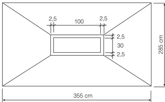
4.º Exercício: Projetar uma sapata para o pilar indicado abaixo, com carga de 3 000 kN e taxa no solo 0,3 MPa.
