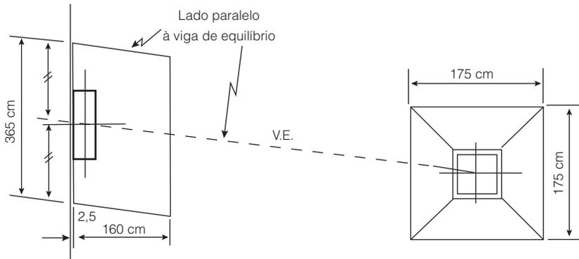
8.º Exercício: Projetar uma viga de fundação para os pilares  $P_1$  e  $P_2$  indicados abaixo, adotando  $\sigma_s = 0,3 \text{ MPa}$ .
