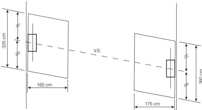
Outra maneira, também bastante difundida entre os projetistas de fundações, é calcular as sapatas supondo-se que a viga de equilíbrio seja uma viga isostática, conforme o esquema abaixo.
