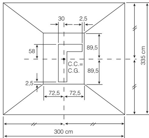
5.º Exercício: Projetar uma sapata para o pilar abaixo para  $\sigma_s = 0,3 \text{ MPa}$ .
