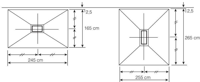
11.º Exercício: Dimensionar a sapata do pilar  $P_1$ , adotando-se para taxa do solo  $\sigma_s = 0,25 \text{ MPa}$ .
