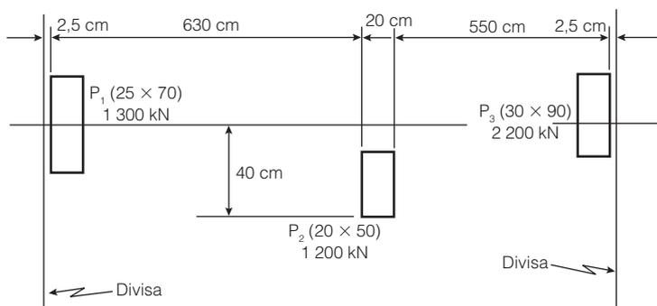
Resposta:  $P_1$  e  $P_3$  alavancados ao  $P_2$ . A sapata do  $P_2$  será dimensionada para uma
