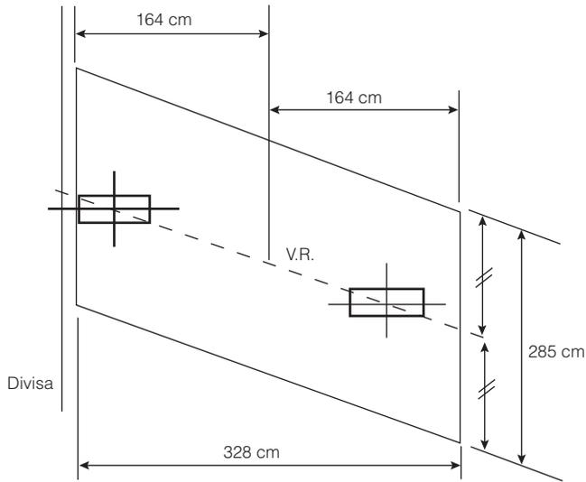
9.º Exercício: Dados os pilares abaixo, projetar uma viga de fundação para os pilares  $P_1$  e  $P_2$ , sendo  $\sigma_s = 0,3$  MPa.
