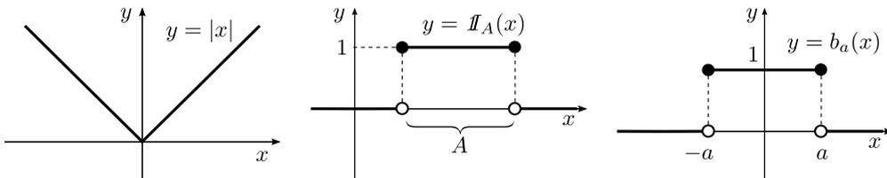
**Figura 1.16:** Da esquerda para direita, os gráficos das funções módulo, indicadora e caixa.
