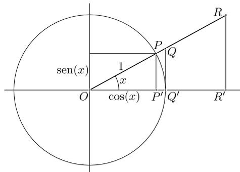
**Figura 1.11:** Definição das funções trigonométricas. Dado um ângulo  $x$  e considerando a circunferência de raio unitário, temos as seguintes relações trigonométricas:  $\text{sen}(x) = PP'$ ,  $\text{cos}(x) = OP$ ,  $\text{tan}(x) = QQ'$ ,  $\text{csc}(x) = OR$ ,  $\text{sec}(x) = OQ$  e  $\text{cot}(x) = OR'$ .
