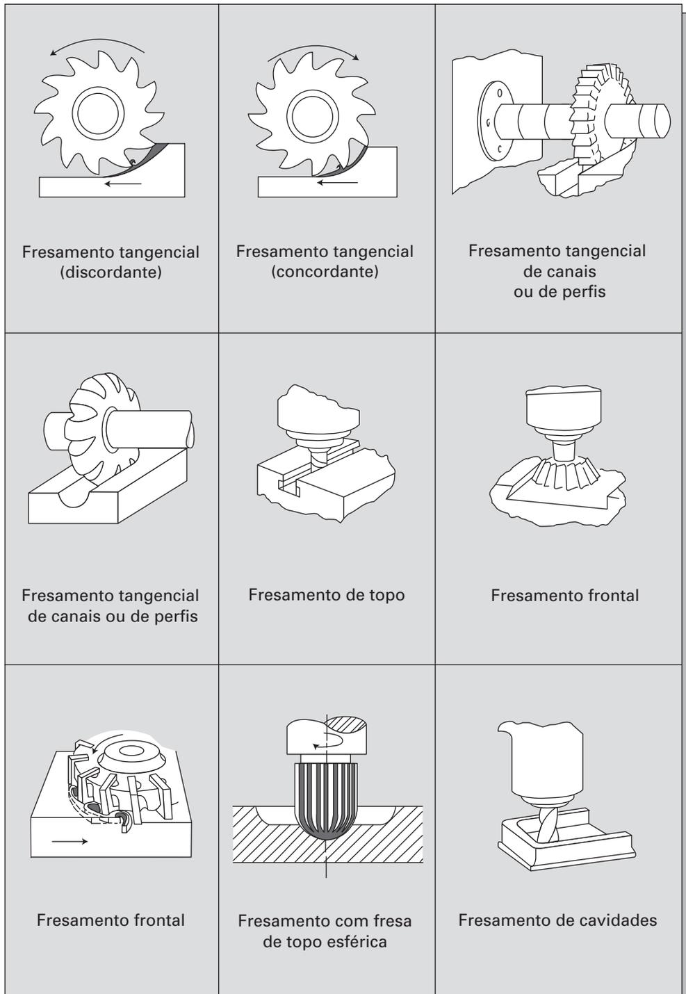
FIGURA 1.4 Principais operações executadas na fresadora.
