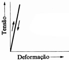
Fig. 1-2. Relação elástica tensão-deformação. A deformação elástica é diretamente proporcional à tensão.
