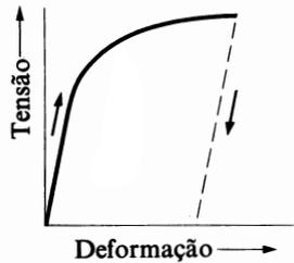
Fig. 1-3. Relação plástica tensão-deformação. A deformação plástica que se segue à deformação elástica inicial não é reversível. A deformação elástica continua a aumentar durante a deformação plástica, mas é reversível. (Compare com a Fig. 1-2).
