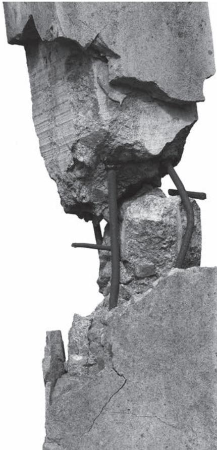
**Figura 2.9** – O uso de concreto armado apresenta uma ruptura menos frágil em função do emprego do aço.
