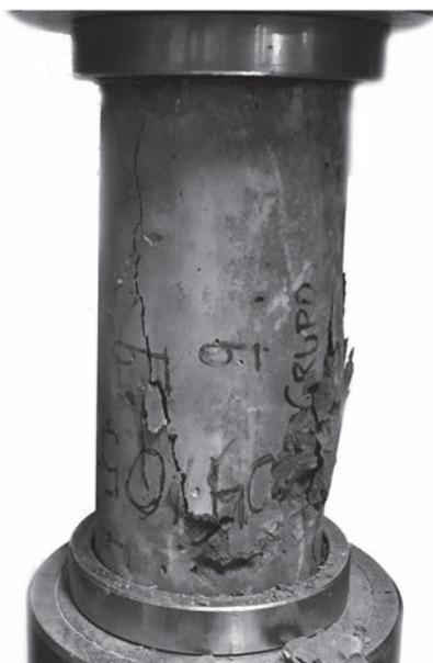
**Figura 2.6** – Corpo de prova rompido à compressão.
