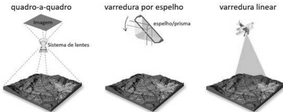
Figura 1.2 – Formas de aquisição de dados espaciais usando-se sensores passivos: (a) quadro a quadro; (b) whiskbroom ; (c) pushbroom .
