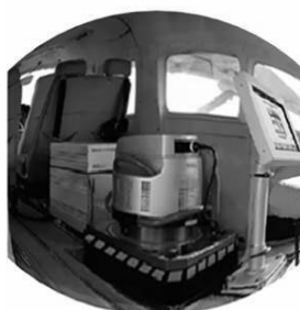
Figura 1.10 – Câmera ADS40 instalada no interior de uma aeronave. Fonte: Sandau, 2010
