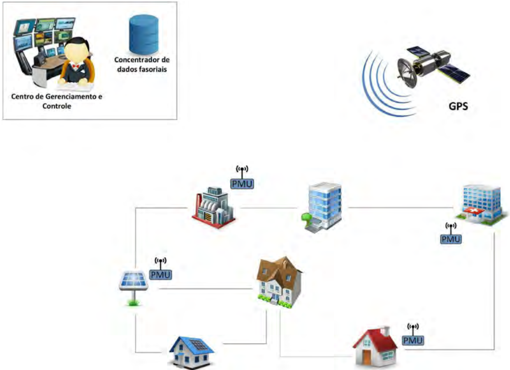
Figura 1.3 – Esquemático de sistema de monitoramento com PMUs.
