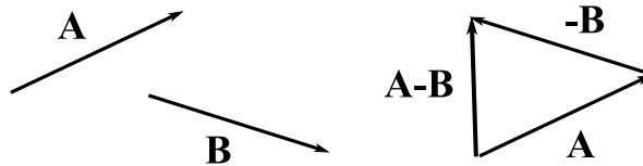
Figura 1.9 – Representação gráfica da aplicação de Método da Poligonal para a obtenção da diferença entre os vetores A e B .
