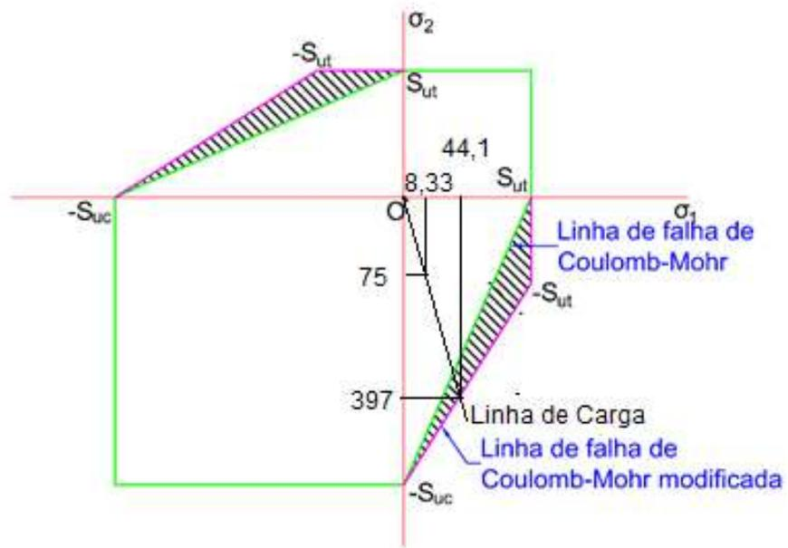
**10.3** - Uma peça de aço AISI 1020 possui o limite de resistência ao escoamento de 380 MPa. Determine o fator de segurança para as três teorias de falha estática para materiais dúcteis, considerando os seguintes estados de tensão:
