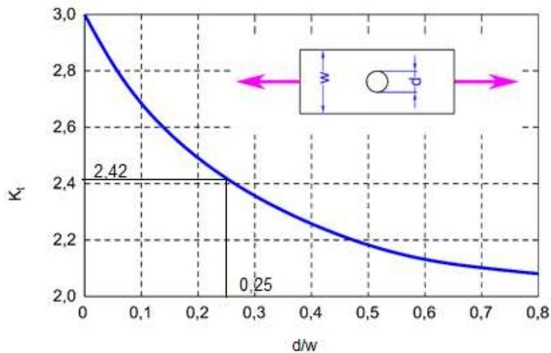
**10.13** - Uma barra de aço de 25 mm de diâmetro possui as seguintes propriedades:  $S_{esc} = 360 \text{ MPa}$  e  $S_e = 162 \text{ MPa}$ . Essa barra deve suportar um carregamento flutuante que varia entre -10 e 50 kN. Determine o fator de segurança utilizando o critério de falha de Soderberg aplicado no dimensionamento da barra, sabendo que sobre a mesma existe um entalhe que produz um fator de concentração de tensões de 1,75.
