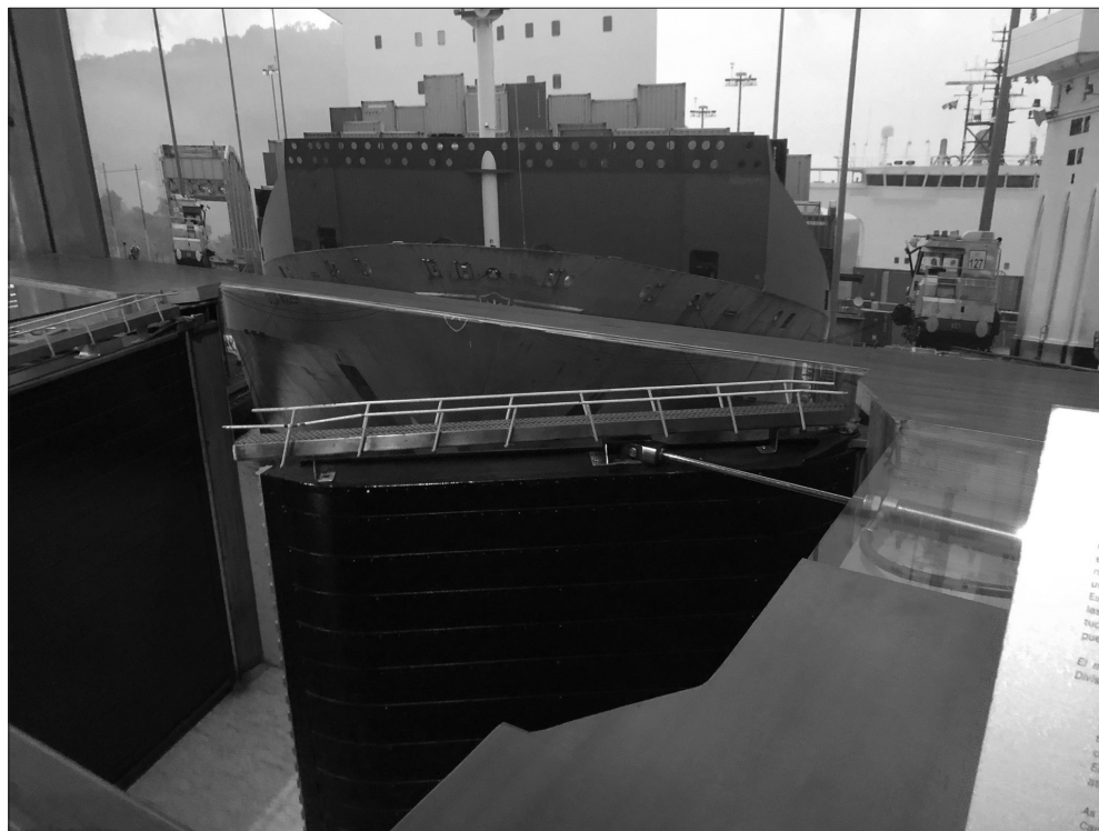
Figura 24.78 Maquete do sistema de acionamento com braço hidráulico com impulso oleodinâmico atualmente empregado nas portas de busco.
