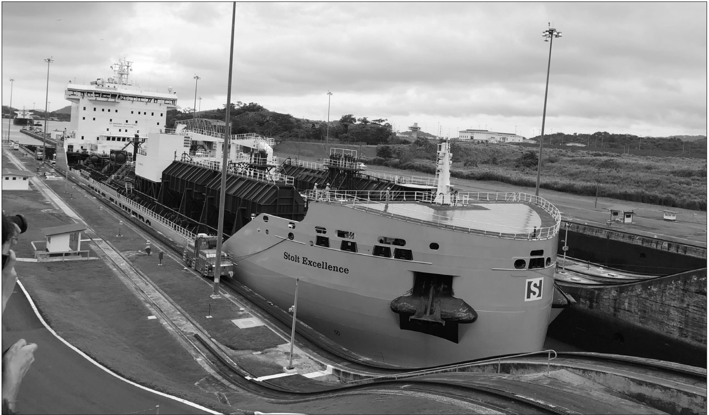
Figura 24.64 Eclusas de Miraflores: com as portas da câmara inferior fechadas, procede-se ao enchimento da câmara.
