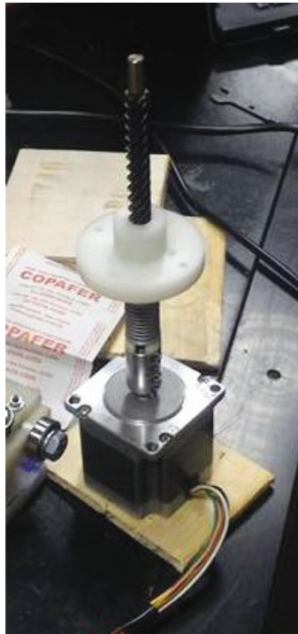
Figura C6 Destaque para o novo conjunto fuso-bucha-acoplamento.
