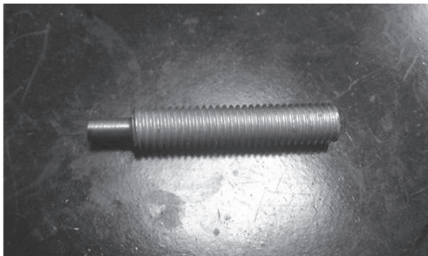
Figura C3 Fuso fabricado a partir de barra roscada.
