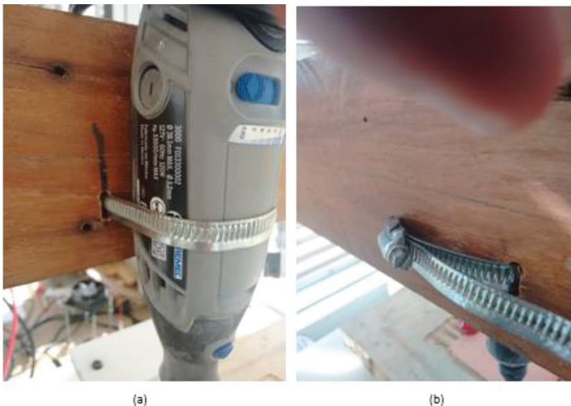
Figura 11 Detalhes de fixação do Dremel à máquina em vista (a) frontal e (b) traseira.
