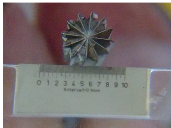
Figura 22 Vista em detalhe, com escala, da ferramenta 3, com evidências de escurecimento e material derretido agregado.
