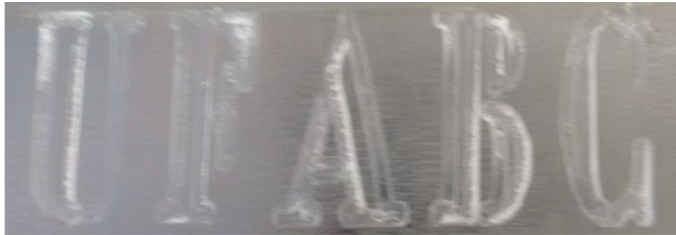
Figura 23 Resultado da gravação do texto em acrílico.
